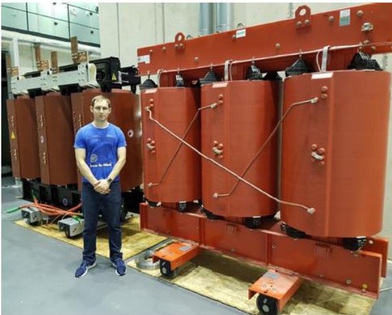
4,5 MVA, 50 Hz Transformer 11.500 kg (2,5 kg/kVA)
