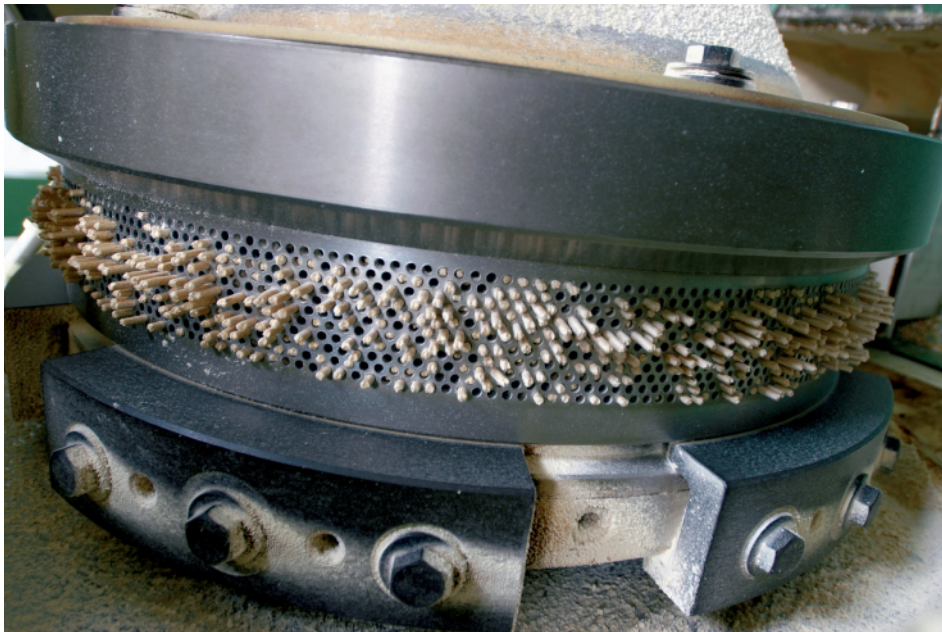
Abb. 10: So entstehen Pellets – Hobel- und Sägespäne werden von Walzen durch einen Stahlring mit Bohrlöchern – die Pelletspresse – gedrückt. Foto: proPellets Austria
