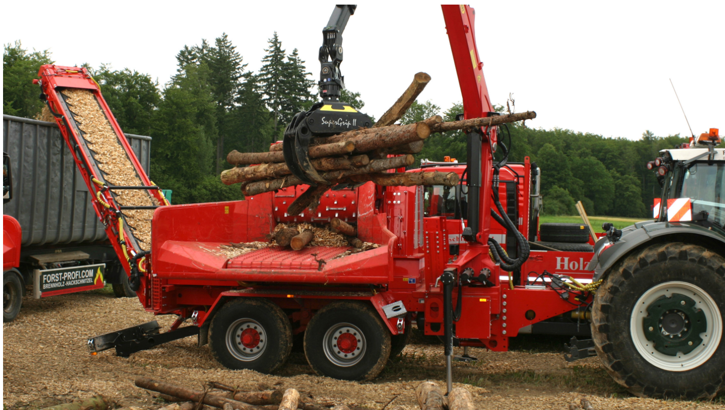
Abb. 6: Die Hackgutproduktion erfolgt oft durch Lohnunternehmer mit mobilen Großhackern.
